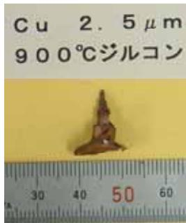
図6 銅粉(2.5μm)焼結品
