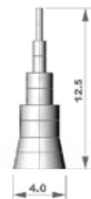
ストキュアを行った。 **図1 試験用光造形模型**
