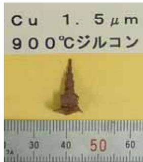
図7 銅粉(1.5μm)焼結品
