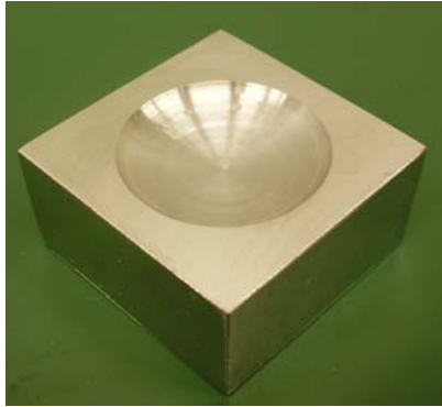
図11 ELID研削したCo-Cr合金の曲面
