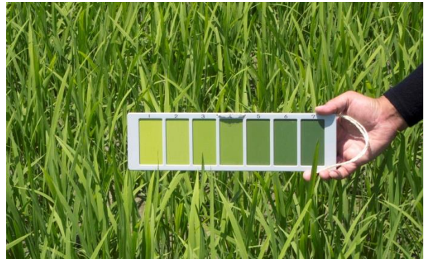
葉色診断 葉色板と稲の葉の色を全体的に比較し、葉色を測定する。
